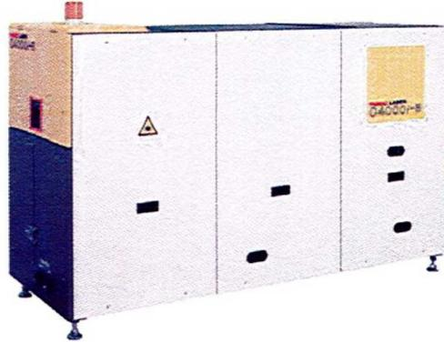
El resonador de láser de CO<sub>2</sub> es una unidad separada, aparte de la máquina de corte por lo que permite diseñar máquinas de corte por láser que abarcan el corte a alta velocidad de material delgado y el corte de alta calidad de material grueso. La unidad contiene el resonador, de elevada estabilidad, suspendido cinéticamente. El resonador de láser incluye comunicación HSSB con el control y un circuito cerrado de refrigeración
