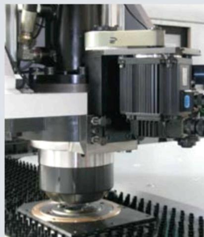
En esta gama se montan los cabezales MULTITOOL INDEX, los cuales convierten a todas las herramientas en rotantes, ofreciendo una máxima flexibilidad.
